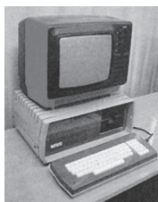
«Агат-7» в металлическом корпусе с монитором на базе ТВ «Юность-404»
